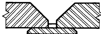
(d) Split Nub Type Backing Ring
